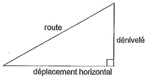
Ainsi une pente de 25% indique un dénivelé de 25 m pour un déplacement horizontal de 100 m.
