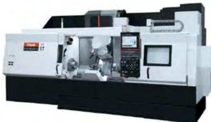
Le diamètre du mandrin de la broche principale est de 8 pouces (203,2 mm) et la machine est disponible avec les options de tourelle inférieure (T) et de broche secondaire (S/ST).
