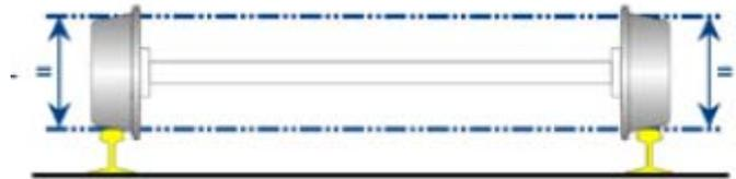
Lors d'un déport, par exemple vers la gauche, le diamètre de la roue gauche au niveau du contact avec le rail droit est supérieur au diamètre de la roue droite au niveau du contact avec le rail, du fait de la conicité des roues. Comme les deux roues sont assujetties à tourner à la même vitesse, cette différence de diamètre provoque un déplacement de l'essieu vers la droite, le ramenant vers la position médiane.
