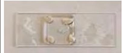
Déposer l'écaille sur le plot de vaseline face tissulaire en-dessous, couvrir de PBS-Ca, ajuster la lamelle et compléter éventuellement avec du PBS-Ca déposé avec une poirette et entrant par capillarité.
