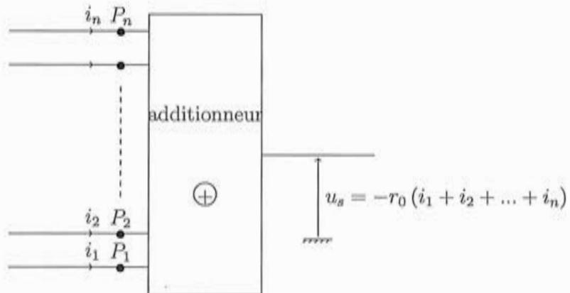
FIGURE 4 – Schéma de principe d'un additionneur. Le montage additionneur délivre une tension proportionnelle à la somme des courants d'entrée. La constante  $r_0$ , homogène à une résistance, est positive. On admet que les potentiels aux points d'entrée  $P_i$  sont nuls :  $V_{P_1} = \dots = V_{P_i} = \dots = V_{P_n} = 0$ .
