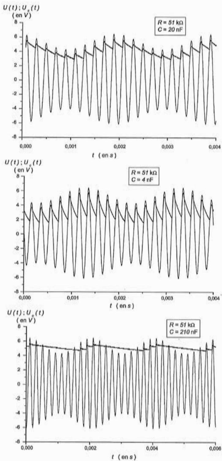
FIGURE 11 – Tensions  $U(t)$  et  $U_c(t)$  mesurées : visualisation du signal avant et après démodulation pour  $R = 51 \text{ k}\Omega$  et différentes valeurs de  $C$  : 20 nF, 4 nF, et 210 nF.
