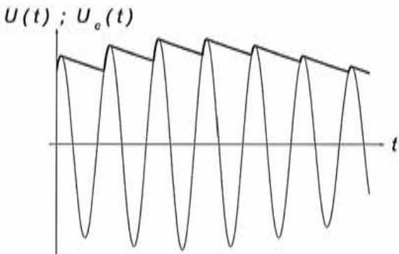
FIGURE 10 – Allure des signaux à l'entrée et à la sortie du détecteur de crête.
