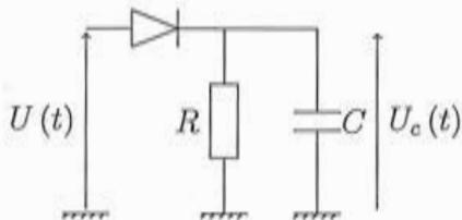
FIGURE 8 – Montage détecteur de crête, constitué d'une diode idéale, puis d'une résistance et d'un condensateur en parallèle.
