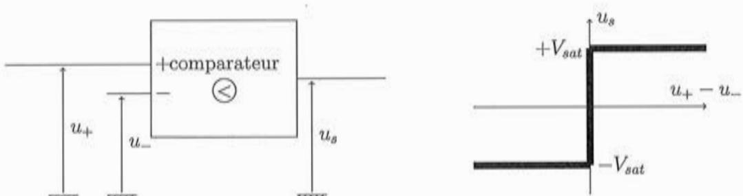
FIGURE 1 – Schéma de principe et caractéristique d'un comparateur. Le montage comparateur délivre une tension  $+V_{sat}$  lorsque la tension d'entrée  $u_+$  est supérieure à la tension d'entrée  $u_-$ , et une tension  $-V_{sat}$  dans le cas contraire.  $V_{sat}$  est positive.
