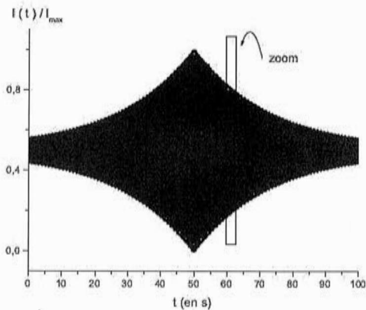
FIGURE 16 – Interférogramme théorique que l'on devrait obtenir avec une diode laser : on mesure l'intensité lumineuse  $I(t)$  au centre de l'écran en fonction du temps, on repère la valeur  $I_{max}$  de l'intensité maximale et on trace le rapport  $I(t)/I_{max}$  en fonction du temps. La zone rectangulaire a été zoomée sur la figure (17).
