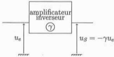
FIGURE 2 – Schéma de principe d'un amplificateur inverseur. Le montage amplificateur inverseur délivre une tension proportionnelle à la tension d'entrée, et de signe opposé. Le rapport  $\gamma$  est positif et peut être plus grand ou plus petit que 1.
