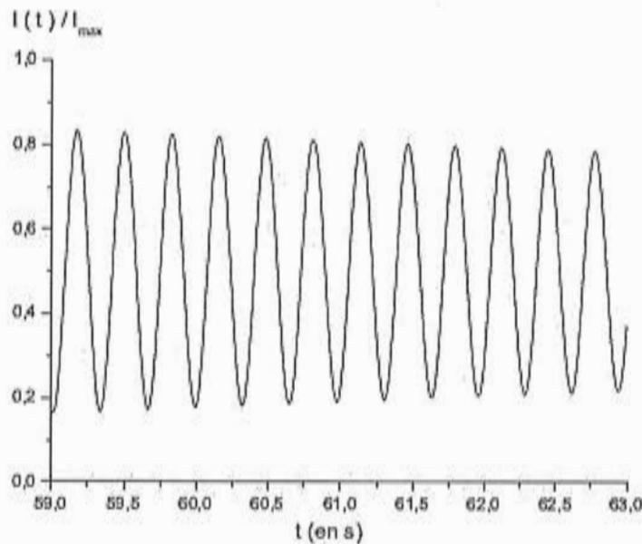
FIGURE 17 – Interférogramme théorique que l'on devrait obtenir avec une diode laser : on a tracé  $I(t)/I_{max}$  en fonction du temps, sur un intervalle de temps de quelques secondes.
