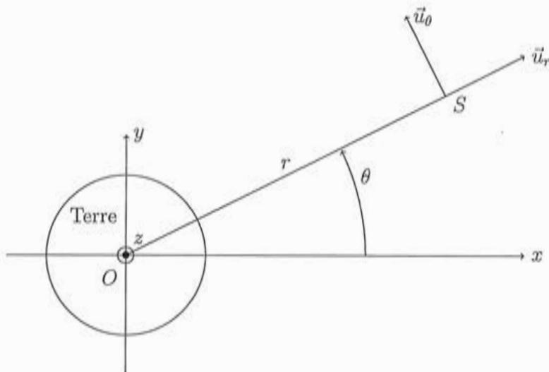
FIGURE 5 – Schéma du satellite  $S$  en révolution autour de la Terre : l'axe ( $Oz$ ) est orthogonal au plan de la trajectoire, et on définit les vecteurs  $\vec{u}_r$  et  $\vec{u}_{\theta}$  comme indiqué sur le schéma.
