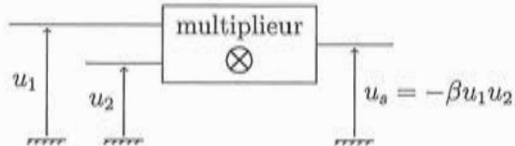
FIGURE 3 – Schéma de principe d'un multiplicateur. La tension de sortie est proportionnelle au produit des deux tensions d'entrée. La constante  $\beta$  est positive.
