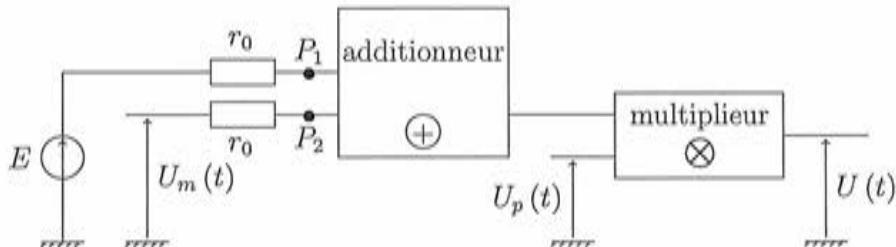
FIGURE 7 – Montage électrique permettant de réaliser un signal modulé en amplitude. La tension  $U_p$  est appelée porteuse et la tension  $U_m$  est la tension modulante.
