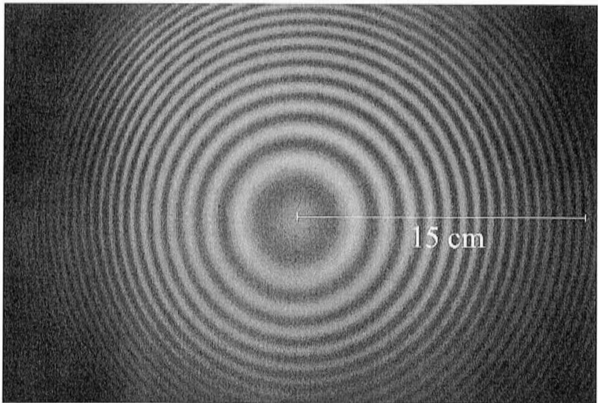
FIGURE 15 – Photographie de l'écran : observation des anneaux dans le plan focal image d'une lentille convergente.
