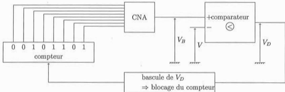
FIGURE 13 – Schéma d'un convertisseur analogique-numérique : la tension analogique à numériser est  $V$ . Un compteur permet de compter en binaire, et grâce à un convertisseur numérique-analogique, de créer une tension  $V_B$  analogique qui augmente tous les  $t_0$ . Les tensions  $V_B$  et  $V$  sont comparées et le compteur s'arrête lorsque la tension  $V_D$  change de signe.
