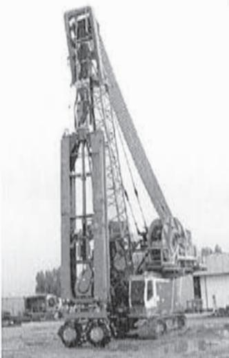
La « bentonite » est une boue constituée d'eau et d'une argile particulière appelée bentonite. Sa propriété principale est la thixotropie (capacité à pouvoir passer de l'état liquide lorsqu'elle est en mouvement, à l'état solide lorsqu'elle est au repos, et inversement). La bentonite permet de remplacer la terre évacuée afin de maintenir la tranchée stable lors du forage et de colmater les éventuelles cavités et fissures existantes dans le sol.
