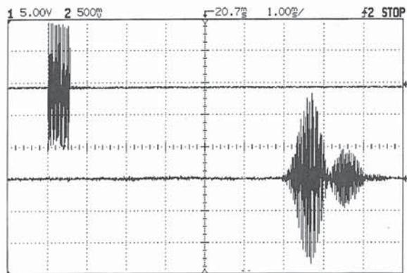
L'émetteur est relié à la voie 1 de l'oscilloscope, le récepteur à la voie 2.
