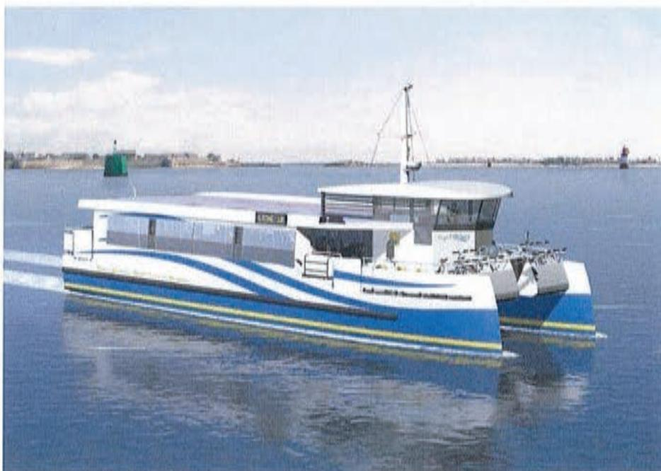
L'Ar Vag Tredan est un **catamaran électrique** sans batteries qui peut accueillir 150 personnes, dont 3 à mobilité réduite, ainsi que 10 vélos. Il est doté de deux propulseurs azimutaux et est capable d'atteindre une vitesse maximum (chargé) de 10 nœuds. Ils permettent à la fois de propulser le navire et d'assurer la direction puisqu'ils peuvent tourner à 360° indépendamment l'un de l'autre.
