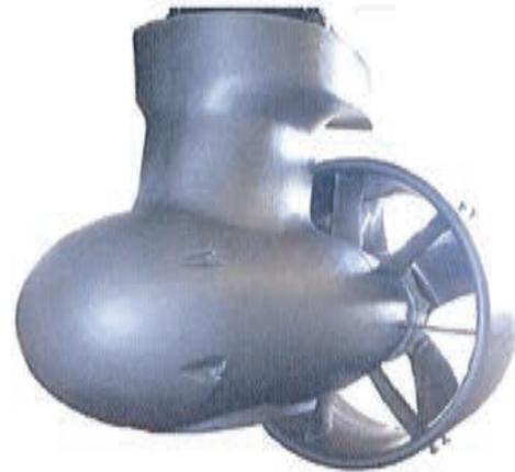
Afin d'éviter les pertes importantes que génère la trainée de deux safrans et des suspentes des arbres d'hélice d'un bateau classique, le choix de deux propulseurs azimuthaux a été fait. Ils permettent à la fois de propulser le navire et d'assurer la direction puisqu'ils peuvent tourner à 360°
