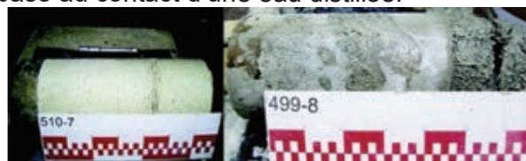
Figure 1 : Éprouvettes après essai de gonflement.
