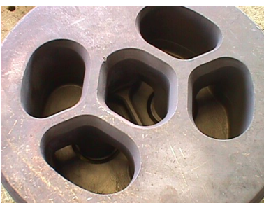
(a) Exemple d'une filière montée vue côté alimentation du métal
