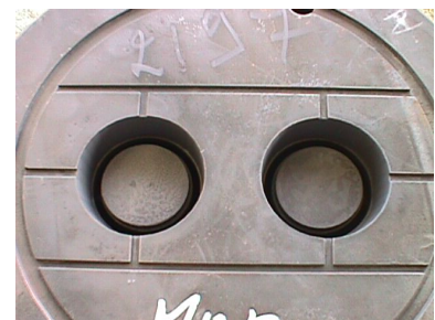
(b) Exemple d'une filière montée vue côté sortie du profil
