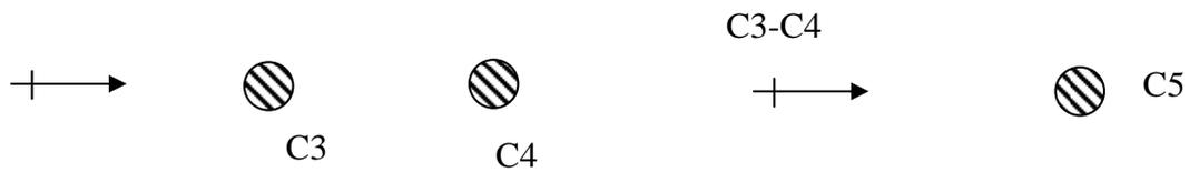
Du fait que la tôle de calage est déjà installée, il ne reste plus qu'à construire un appui linéaire rectiligne et un appui ponctuel (repères C...).
