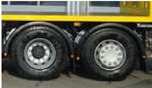
Le véhicule est équipé de pneumatique : G.315/80 R 22,5 RHSII / RHDII et d'ailes de la Gamme SUPRA avec des bavettes anti-projection.
