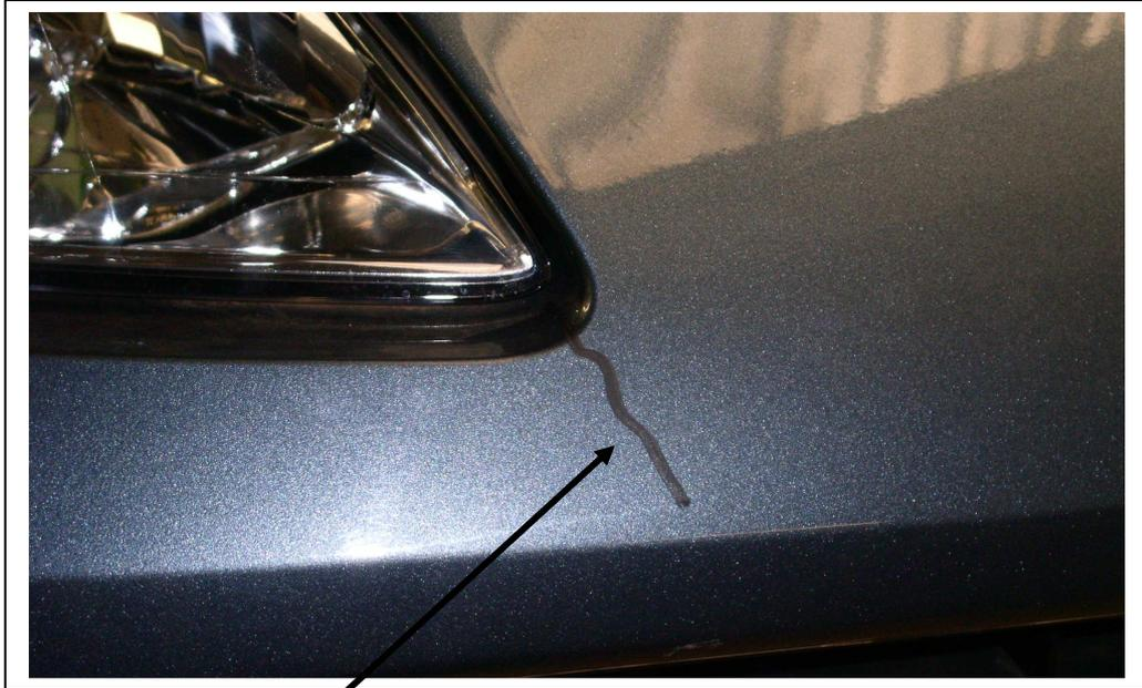
Fissure débouchant sous optique de phare (bouclier en polypropylène)
