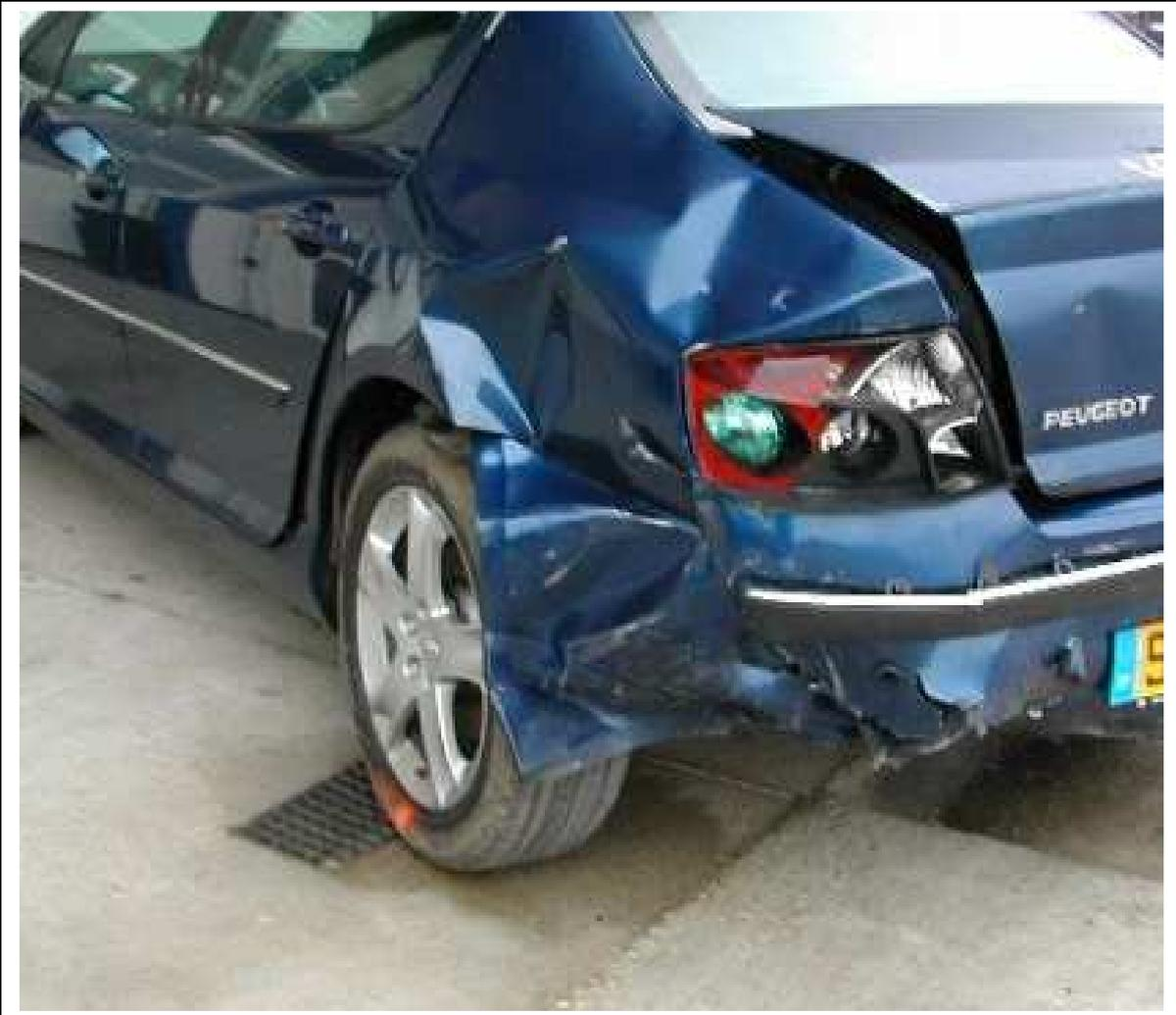
Lors de la réparation du choc arrière, l'opérateur doit remettre en ligne par vérinage (vérin vecteur) le longeron arrière gauche.
