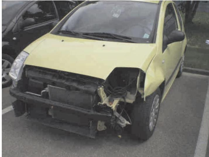
**Éléments à remplacer : longeron avant gauche + élément « appui de façade »**
