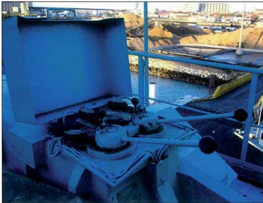
Levier de manœuvre pour le changement de vitesse.
