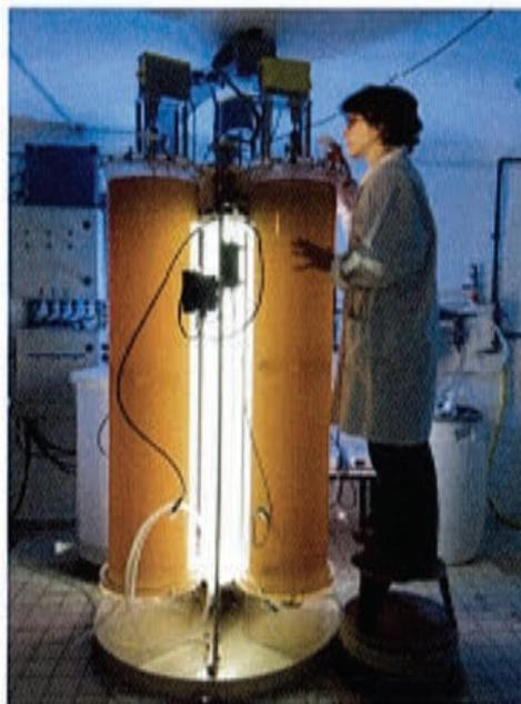
Figure 4 : Photobioréacteur pilote IFREMER avec éclairage artificiel.
