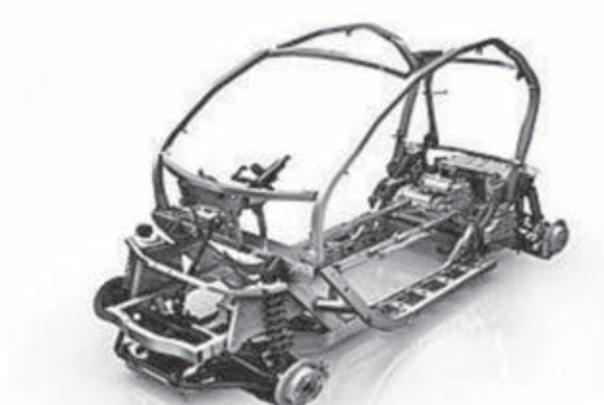
Les éléments de carrosserie de Twizy sont, quant à eux, en matière plastique et sont attachés à la structure d'acier par clipsage, ce qui permet un assemblage rapide.
