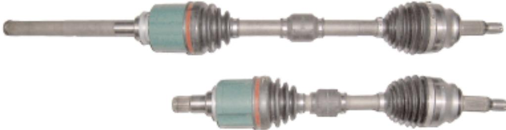
La transmission droite est plus longue, pour pouvoir traverser le transfert jusqu'au différentiel avant. Le transfert fait office de palier intermédiaire.
