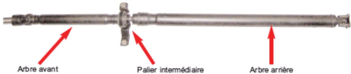
La transmission est équilibrée à l'aide de masses soudées. Elle intègre un Damper au niveau de l'arbre arrière (intégré dans le tube).
