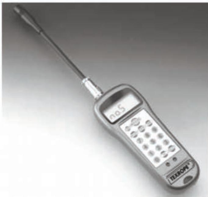
Le tensiomètre sonique opère par l'analyse des ondes sonores produites par une courroie qui vibre. Une courroie vibre à une certaine fréquence, déterminée par sa tension, sa masse et par la longueur du brin. Le tensiomètre mesure cette fréquence et la convertit en une valeur de tension.
