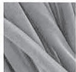
À partir du procédé viscose, des essais ont été réalisés afin d'inventer des solvants permettant de dissoudre directement la cellulose. Parmi *Fibres Tencel<sup>®</sup>* [*Lenzing-Tencel<sup>®</sup>*] eux, le *N*-Methylmorpholine-*N*-Oxide (NMMO) s'est avéré être la meilleure solution technique. Non toxique et recyclable, le NMMO a un faible impact sur l'environnement.
