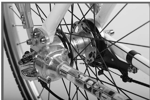
Figure 2 - Moyeu de la roue arrière à 3 vitesses
