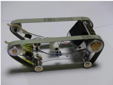
Il a été demandé aux candidats de réaliser un mini véhicule nommé « robot explorateur ». Sa fonction principale est d'explorer l'intérieur d'une canalisation afin de la filmer par l'intermédiaire d'une mini caméra numérique fixée dessus. (dimensions : 27 cm x 14 cm x 10 cm – poids : 1,5 kg). L'épreuve finale s'est déroulée du 18 au 22 mai 2015 au lycée des métiers Charles et Adrien Dupuis au Puy-en-Velay en Haute-Loire.
