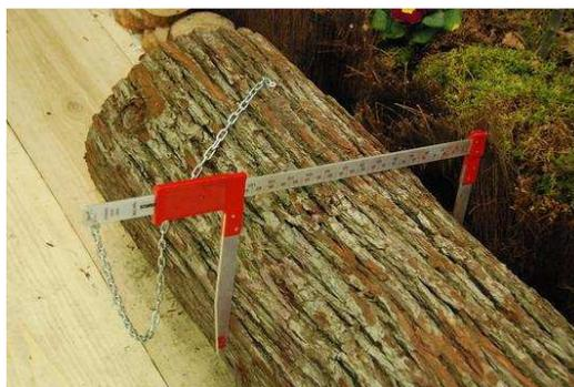
La comparaison avec un pied à coulisse de forestier réel (ou l'observation de photos) permet de reconnaître les différents éléments imaginés : la règle graduée et une butée fixe solidaire de la règle, ainsi qu'une autre butée qui coulisse le long de la règle, chaque butée étant perpendiculaire à la règle. Les élèves légendent un schéma ou une photo de pied à coulisse et élaborent le mode d'emploi de cet instrument.
