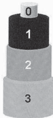
Figure 6.1 : câble électrique sous-marin : âme en aluminium (0), gaine en PVC (1), gaine en plomb (2), gaine en polyéthylène (3).
