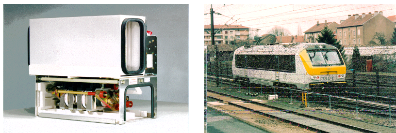
Figure PG.4 : module à GTO du hacheur d'entrée 1.5MW pour une locomotive de 6 MW utilisant 4 hacheurs multicellulaires.
