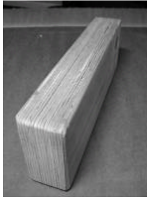
Figure 4. Élément de poutre en lamibois
