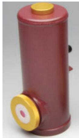
FIGURE 14 – Photographie d'un cylindre contenant un détecteur utilisé dans des spectroscopes IRTF et refroidi à l'azote liquide.
