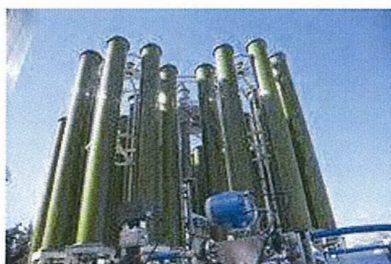
PBR « airlift » à colonnes verticales
